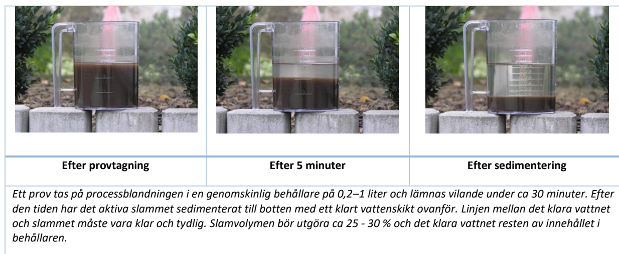
Figur 2: Kontroll av slammängden i processtanken
