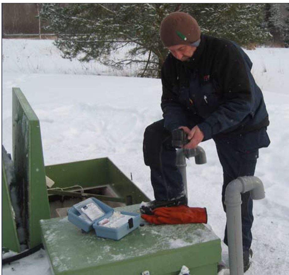
Mätning av vattnets fosforinnehåll i fält. Metoden används vid intrimning av kemikaliers dosering på reningsverk samt kontroll under drift.
