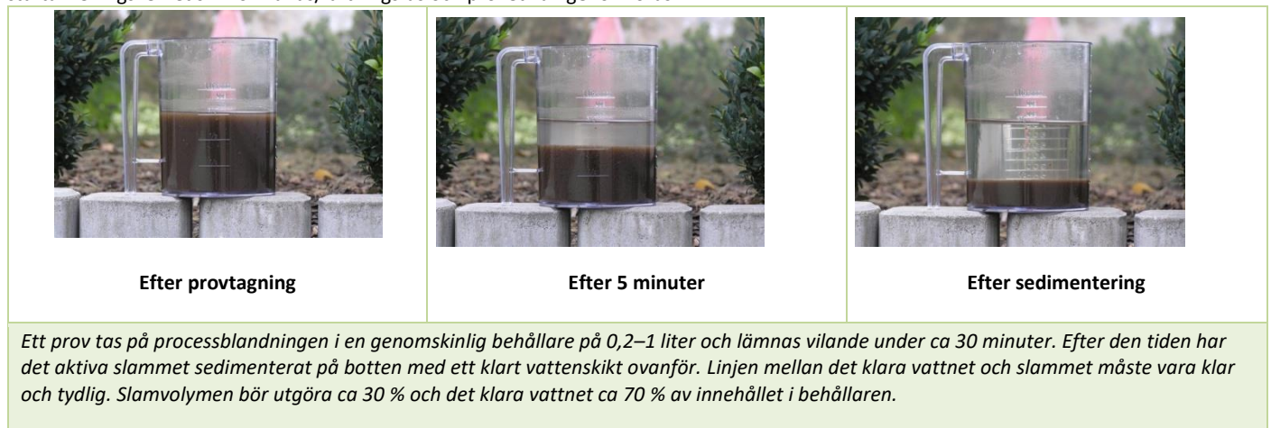
Figur 2: Kontroll av slammängden i processtanken
