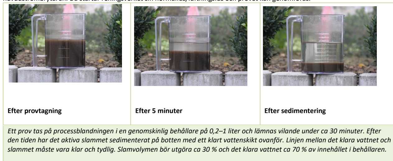
Figur 2: Kontroll av slammängden i processtanken
