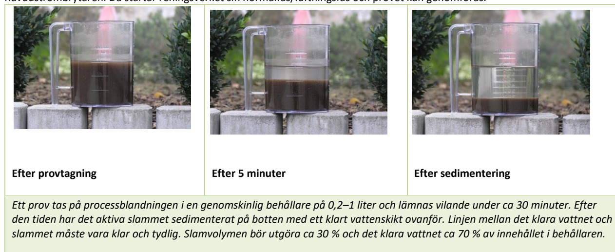
Figur 2: Kontroll av slammängden i processtanken
