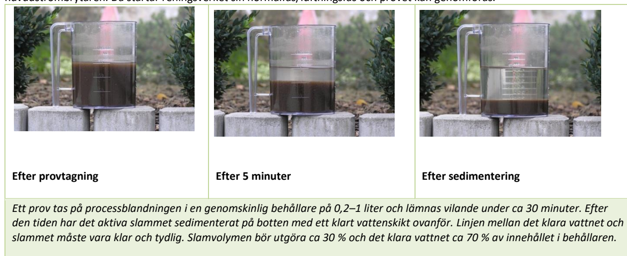
Figur 2: Kontroll av slammängden i processtanken
