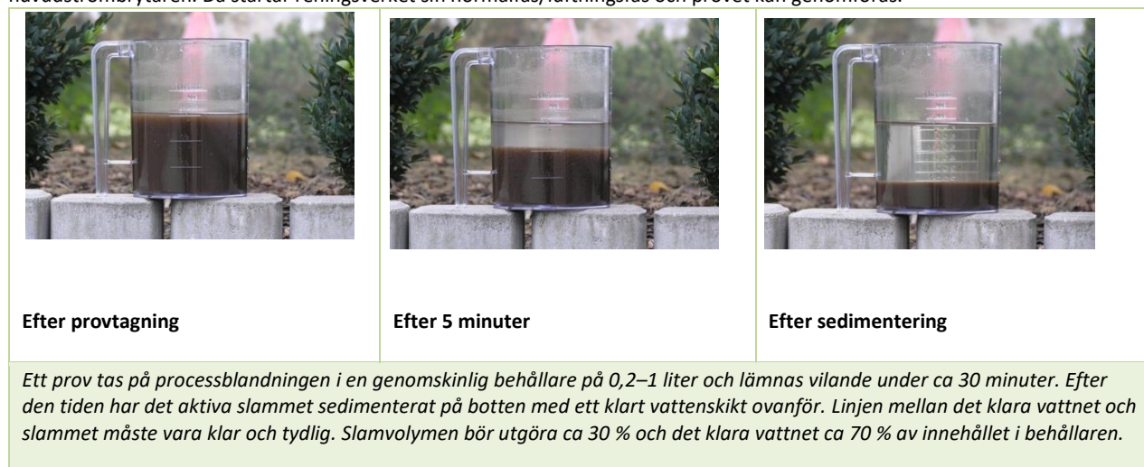
Figur 2: Kontroll av slammängden i processtanken
